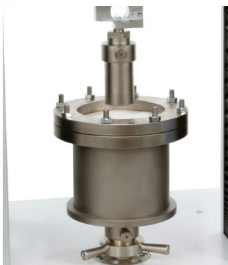
CBR perforation Testing Kit for non-wovens (EN ISO 12236, UNI 8279-14), Code 2510.690
